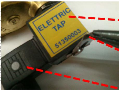
**C** Estrarre il morsetto **A** svitando l'apposita vite (non visibile in figura) e il blocco **B** con una pinza o a mano libera per liberare la bobina **C**
