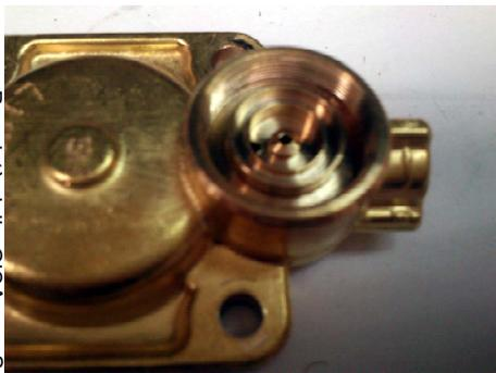
Sede Cilindro **D** nel corpo valvola senza guarnizione **H**
