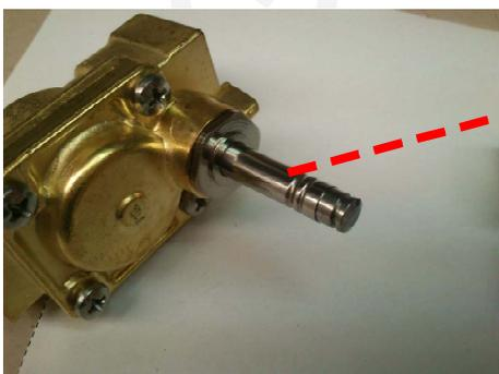
Valvola senza bobina **C**; visibile cilindro **D**
