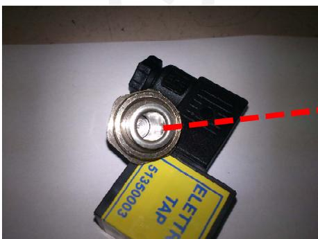
**E** Interno cilindro **D** **OCCORRE VERIFICARE CHE NON VI SIANO DEPOSITI DI CALCARE INTERNAMENTE; IN TAL CASO TOGLIERLI CON ACIDO.**
