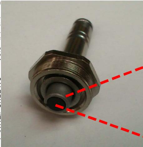
Cilindro **D** svitato: si vede il pistoncino **E**. Guarnizione **T** del pistoncino. Occorre assicurarsi che tale guarnizione sia sempre diritta al suo posto come in figura.
